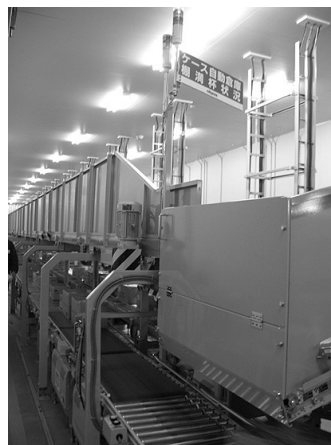
【写真2】ケース自動倉庫 商品は個数ごとにパレット倉庫から取り出され、ケース自動倉庫に運ばれる
