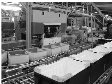
【写真4】 セットボックス 取り出された商品は奥の箱に入れられ、袋詰めされる。4袋単位で手前のセットボックスに入れられる
