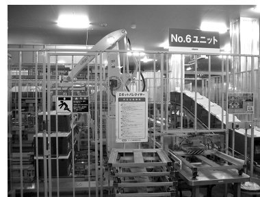
【写真5】 セットボックスはロボットが自動で積み上げていく
