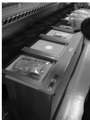
【写真3】 1個単位で商品を仕分けるピカトル1（ワン）。LEDランプのついた皿の上に商品を置きなさいと指示が出る
