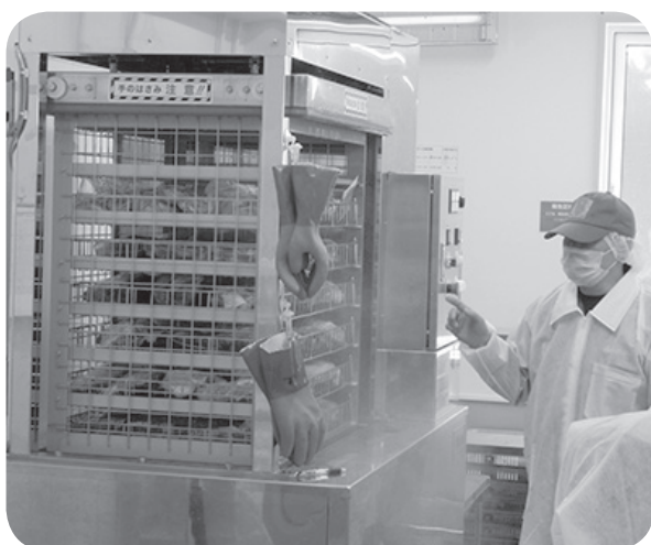
▲北海道シュヴルイユ浦臼工場の液体急速凍結機。 ドリップの少ない高い品質の処理が行えます。
