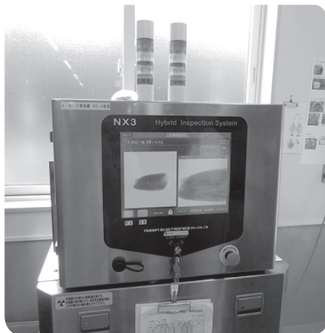
▲北海道シュヴルイユ浦臼工場の金属検出機。 金属検出機とX線装置とのハイブリット機を導入し ており、非金属異物の検出も可能としています。
