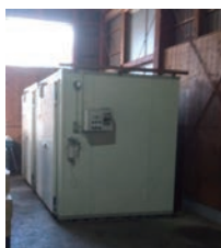
▲収穫したゆずの腐敗対策として高温予措庫で乾燥
