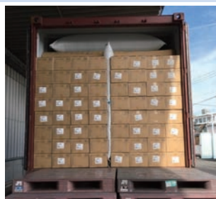
▲ 現地配送し易い18本用ケースが崩れないよう低く積載。空間にエアバッグを入れ安定させる
