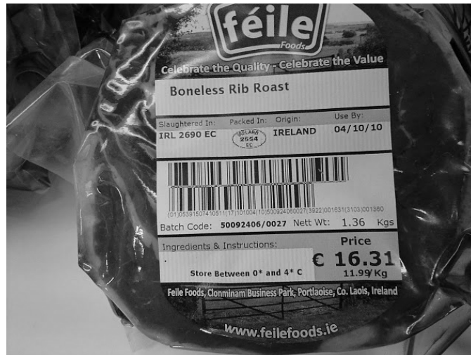
図表 -3 欧州で精肉のソースマーキングに利用される GS1 データバー (GTINに加え、売価、重量、消費期限などをバーコード化)
