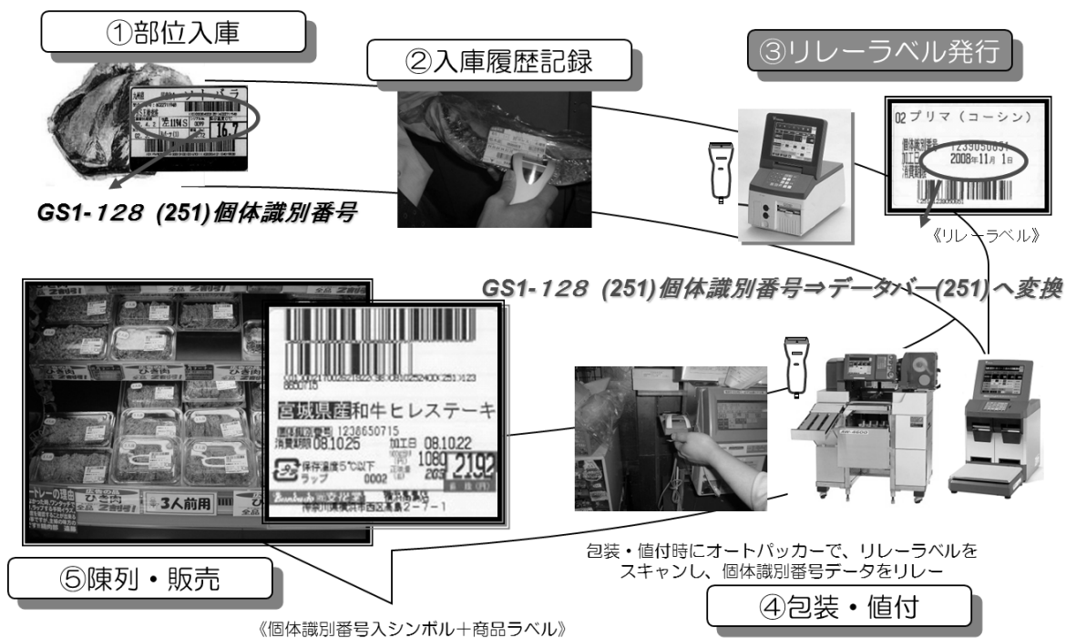
図表 -5 AI による複数種類バーコード間での個体識別番号の伝達例
