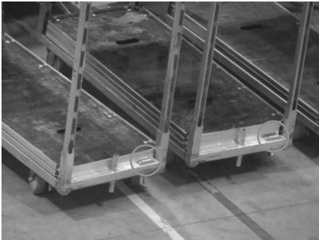
台車に付いた RFID に情報を載せて物流管理
