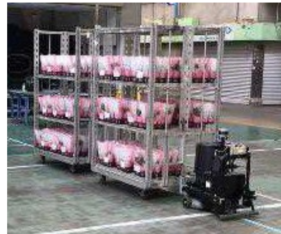
無人搬送機により 一貫流通台車を 搬送する様子
