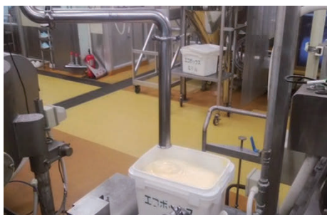
生産のアイテム切り替えの際にマヨネーズ残さが出荷量の 0.07%発生してしまう
