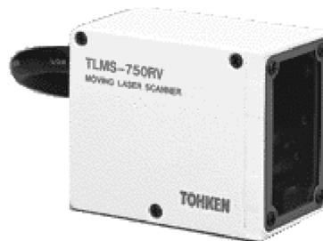
光源には、半導体レーザー（可視光、赤外光）、He-Neレーザー、ガスレーザーなどを採用。近年では寿命が長い、衝撃に強い、小型化が可能、などといった理由から、半導体レーザーを光源に採用するケースが増えています。自動走査方式には、シングルスキャン（一線上を走査）とラスタースキャン（多段走査）があり、移動物体の自動読み取りに効果的です。
