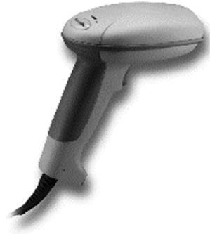
光源に複数の発光ダイオード、受光素子にイメージセンサを採用。スキャン回数が多く（40～100スキャン/1秒）、バーコード読み取り口を当てるだけで読み取り可能。曲面やビニールに印刷されたバーコードの読み取りも可能ですが、読み取り口より大きなバーコードの読み取りには適していません。
