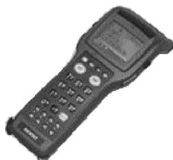
従来、バーコードリーダなどの入力装置を装備したハンディターミナルの形態は、入力装置とハンディターミナル本体がケーブルで接続されているのが一般的でした。そこで片手で操作でき、作業効率の向上を実現させるために開発されたのが、このスキャナー一体型ハンディターミナルです。ペンタイプは貨物追跡、センター内仕分けなどの「入出庫管理」、タッチタイプはスーパーなどの検品・棚卸、工場での工程管理などの「伝票チェック」に多く活用されています。
