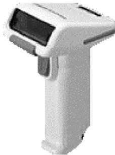
光源には可視光または赤外光半導体レーザーを採用。発光されたレーザービームがモニターに取り付けられたミラーで左右にスキャニングを行い、バーコード面上から反射された光をフォトセンサーで受光します。セルフスキャン方式なのでオペレータによる読み取り率の差がなく、高い読み取り率を実現。また、これまで赤外光半導体レーザータイプで読み取りできなかった、サーマル紙、青色ラベルのバーコードも可視光タイプなら読み取りが可能です。
