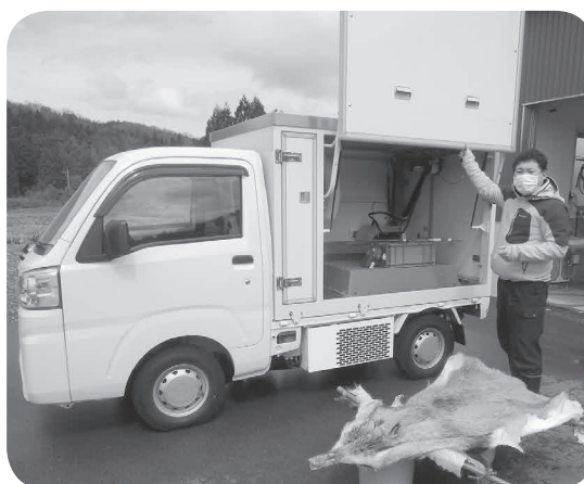
上：移動式解体処理車「ジビエジュニア」。吊り下げて運んだり冷却したりすることも可能。
